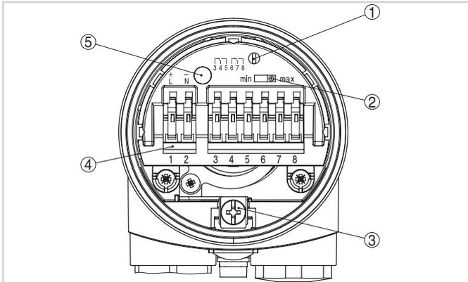
Отсек электроники и подключения - релейный выход
